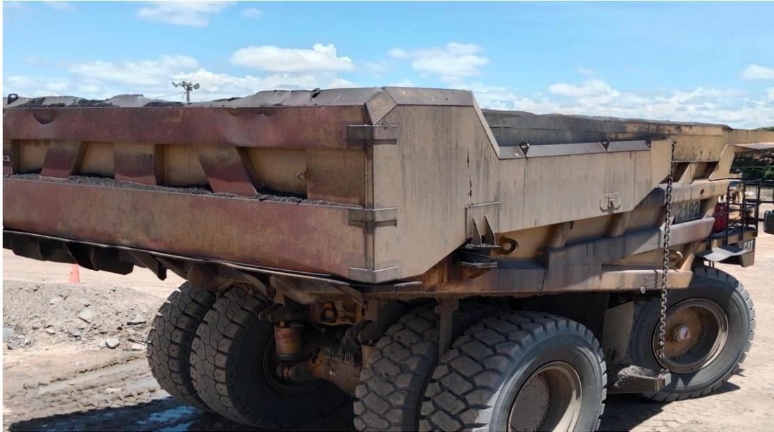
Nota: se observa la modificación de una compuerta que altera sustancialmente la capacidad de carga y viola las condiciones de seguridad del equipo con el objetivo de realizar mayor cargue.
