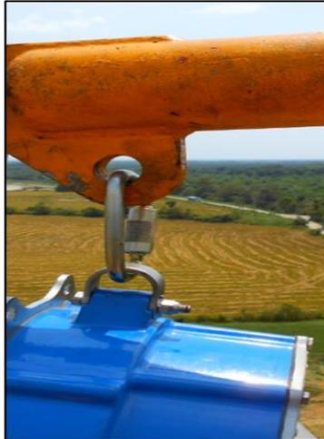
**Imagen 17.** (Conector en el Mecanismo Primario de Sujeción de Dispositivo Retráctil – SRL)
