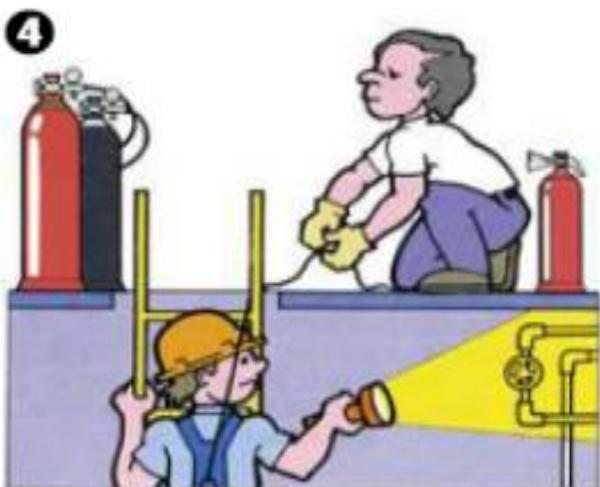
**4** Entrada en las condiciones establecidas y con medios y equipos adecuados (ventilación suficiente, protecciones personales, escalera, cuerda de salvamento sujeta desde el exterior, etc.).
